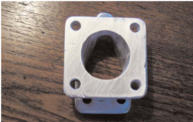
Das Übergangsstück aus Sicht des SU-Vergasers
