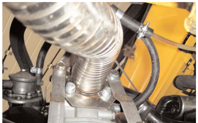
Flansch zwischen Vergaser und Ansaugrohr
