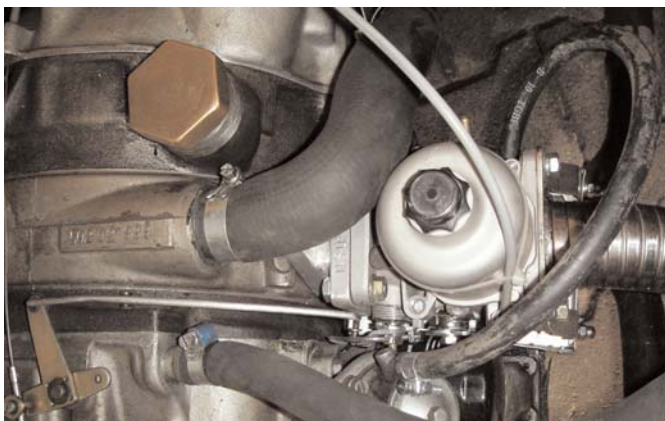
Bei genauem Hinsehen erkennt man das verbogene Gasgestänge
