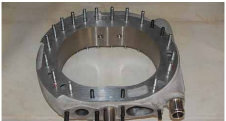
Das Herzstück des NSU Wankel-Spider-Motors - Die Trochoide
