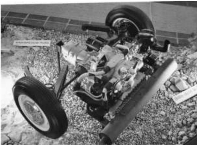
Bei der Antriebseinheit auf dem Messestand ist zu erkennen, dass der Motor noch weit entfernt war vom späteren Serienmotor. Was unter anderem an der falsch platzierten Wasserpumpe und der Auspuffanlage zu erkennen ist.
