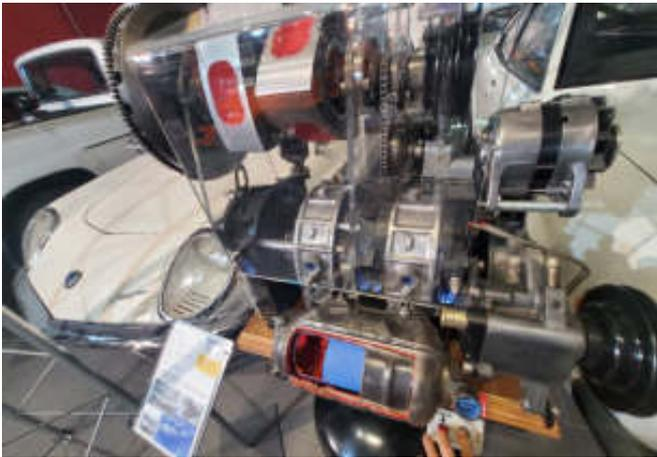
Per Knopfdruck kann man hier das Schnittmodell eines 2-Scheiben-Kreiskolbenmotors „in Schwung bringen“.
