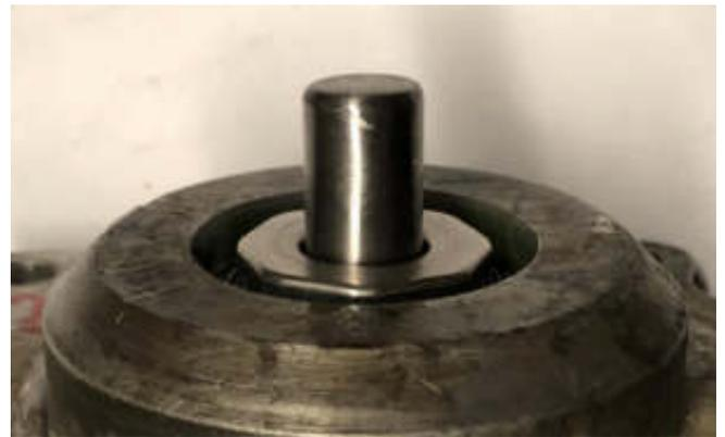
minimalen Ringspalt zum Gehäusedeckel aufweist und deshalb nur geringe Rückströmverluste auftreten. In der Serienausführung war der verlustbringende Ringspalt zwischen Pumpenrad und Gehäusedeckel ein Ergebnis der Toleranz der Bauteile und konnte nicht exakt minimiert werden wie mit dieser beschriebenen Reparaturlösung.
