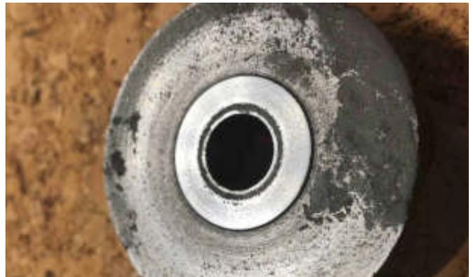
Auf eine weitere Verschiebung des Pumpenrades hin zu höherer Federkraft des statischen Dichtungsteils wurde verzichtet, da sich dadurch der Abstand der Pumpenflügel vom Gehäuse vergrößert und dieser Spalt die Pumpenleistung deutlich reduzieren würde.
