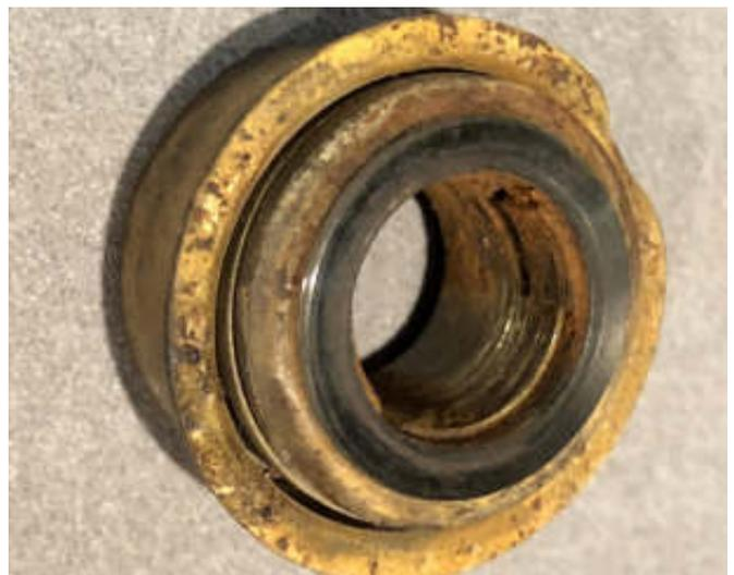
Die Realität zeigte ein anderes Bild. Die Dichtfläche ist teilweise korrodiert und zeigt tiefe Rostporen. Dieser Zustand ist typisch für alte Kühlsysteme die ohne Frostschutzmittel – das auch als Korrosionsschutz wirkt – betrieben wurden und sehr lange Stillstandszeiten hatten.
