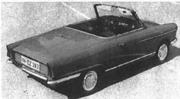
Bild 1 und 2. NSU-Spider mit Wankelmotor als Heckantrieb, 54 PS, ca. 150 km/h; selbsttragende Karosserie
