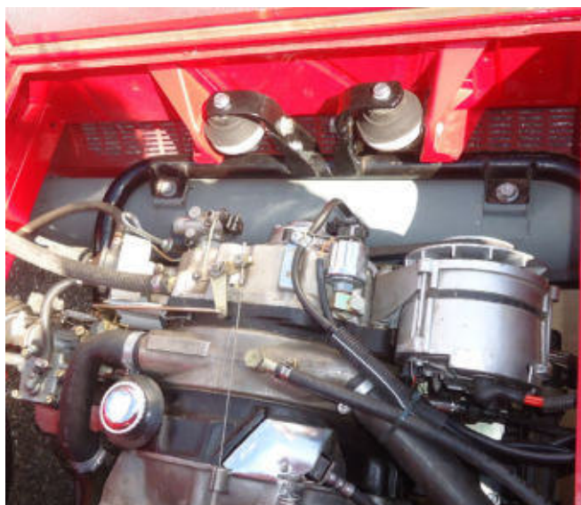
Hintere Motoraufhängung aus dem Audi A6
