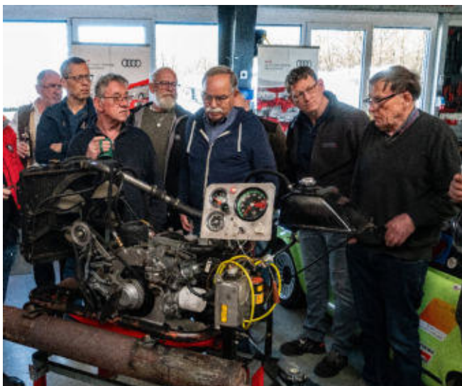
Ein neu aufgebauter Wankelmotor wird erstmalig gestartet
