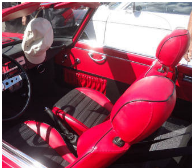
Sitze aus dem Mazda MX 5 im Wankel-Spider Design mit Kopfstützen
